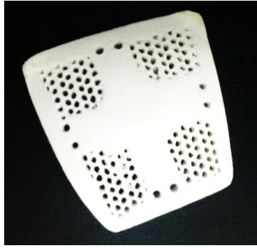
Figura 4.33. Implante fabricado por FDM, caso de estudio 2.
