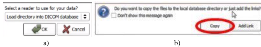
Figura A.3. Opciones para importación de archivos DICOM en 3DSlicer®: a) Load directory into DICOM database, b) opciones “Copy” o “Add link”.
