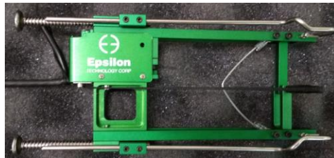
Figura 3.2. Extensómetro de galgas Épsilon® modelo 3542-050M-050-ST con 50 mm de longitud y rango de medición de \pm 10 \% .
