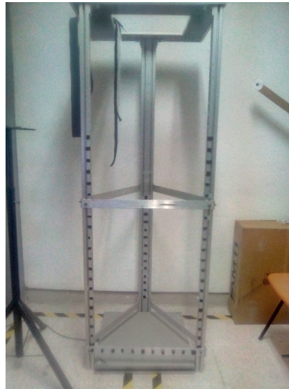
Figura 4.3: Estructura patrón para la calibración de cámaras.
