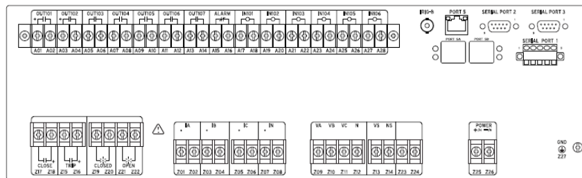
Figura 12. Vista posterior del relevador SEL-351S
