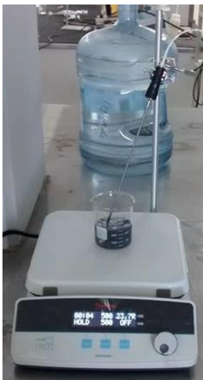
Fig. 9. Sensor de temperatura acoplado a una parrilla de agitación magnética en donde se llevaron a cabo las pruebas para la determinación de parámetros termodinámicos.
