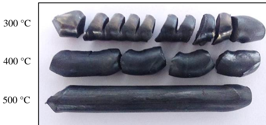
Fig. 2.6. Probetas extruidas con 1P por ECAP a diferentes temperaturas.
