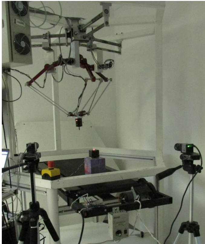
Figura 2.3: Plataforma PARALLIX LKF – 2040, sistema de visión y de desplazamiento.
