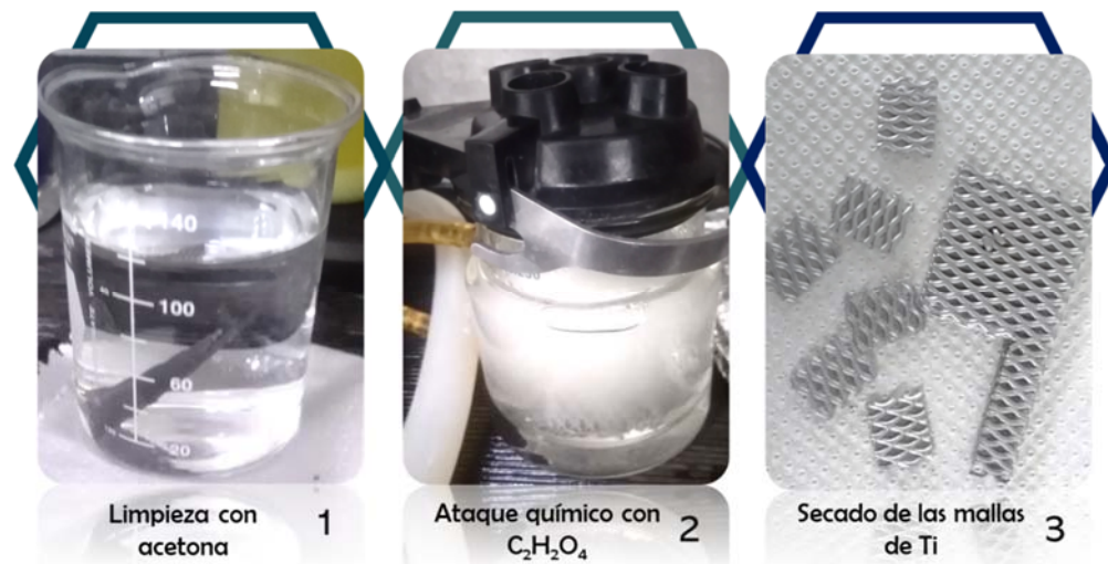
Figura 14. Etapas del ataque del sustrato con ácido oxálico ( C_2H_2O_4 ).
