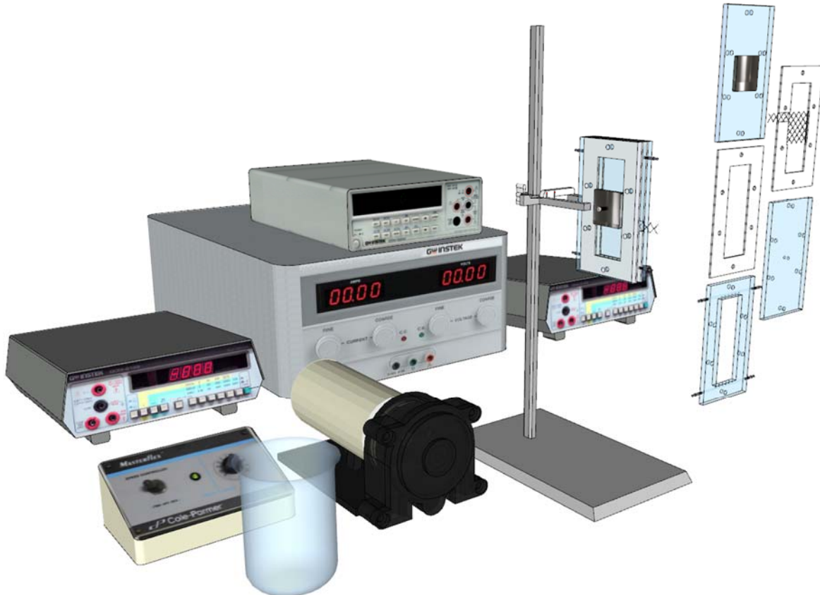
Figura 20. Equipo y material utilizado en el desarrollo de las pruebas de macroelectrólisis.
