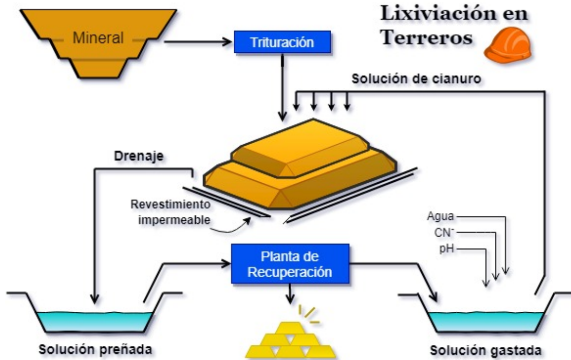
Figura 1. Etapas del proceso de obtención de Au con soluciones de cianuro.
