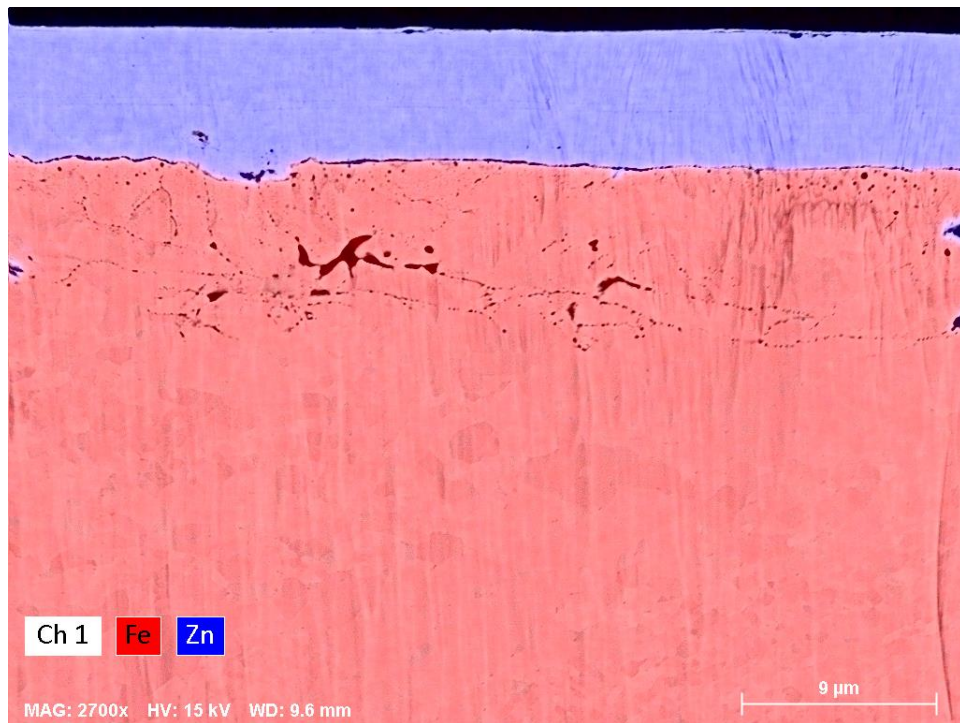
Figura 3.11: Mapeo de composición elemental obtenido mediante MEB-EDS en el acero AISI-1075 recubierto con zinc.
