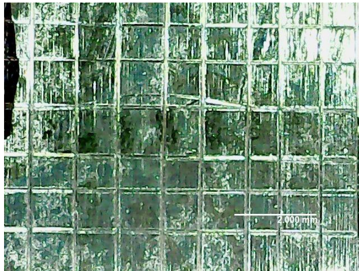
Figura 3.14: Prueba de adherencia por rayado en láminas de acero AISI-1075 recubiertas con zinc. Cuadrículas de 1 mm x 1 mm.
