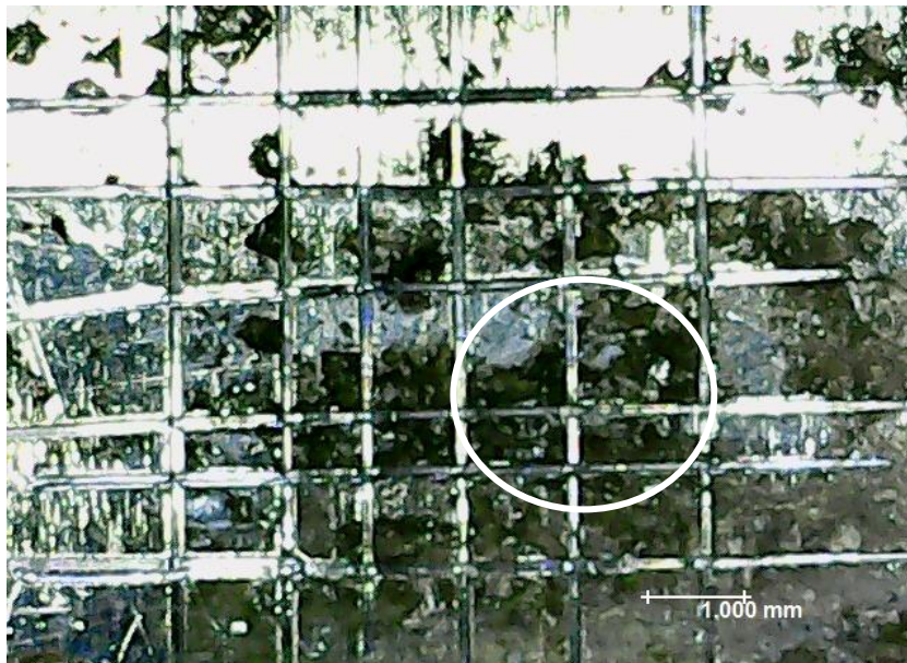
Figura 3.22: Prueba de adherencia por rayado en lámina de acero AISI-1075 cincado y con recubrimiento de Ag, activada con HCl-10% (experimento 1.1).
