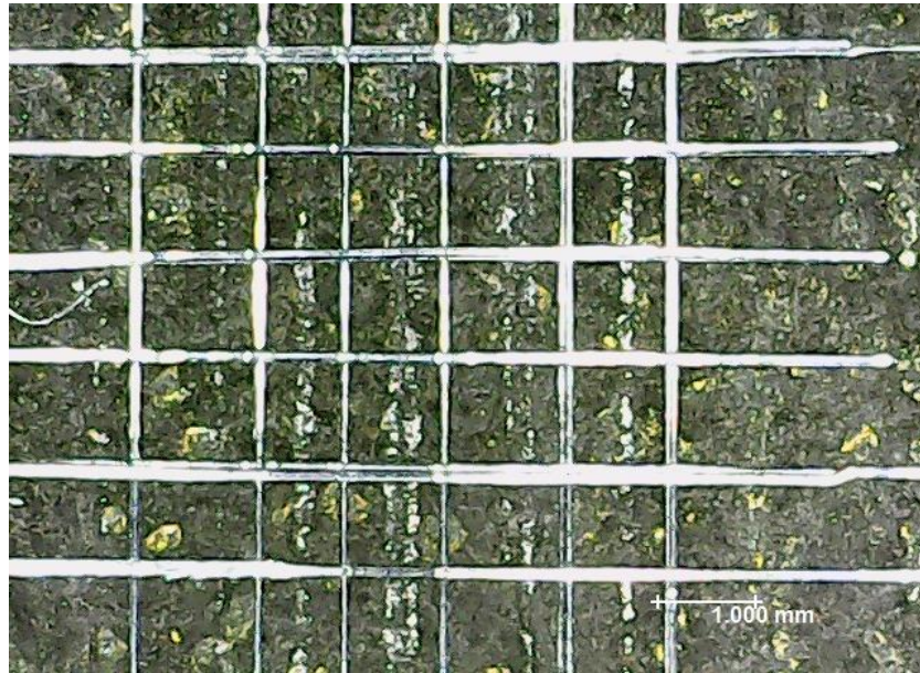
Figura 3.23: Prueba de adherencia por rayado en lámina de acero AISI-1075 fosfatado y con recubrimiento de Ag, activada con NaOH-5% (experimento 1.1).
