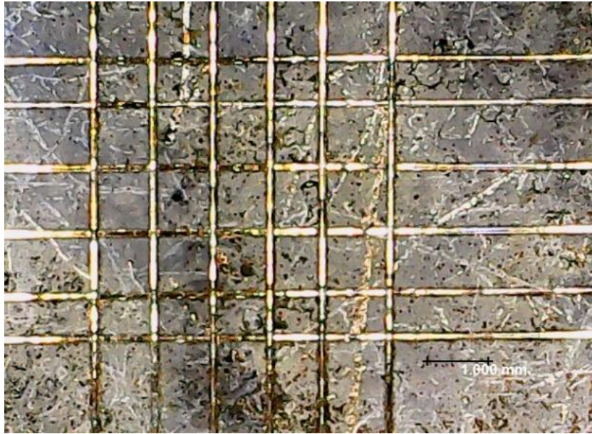
Figura 3.29: Prueba de rayado en lámina de acero AISI-1075 cobrizado y con recubrimiento de Ag, activada con H 2 SO 4 -5% (experimento 1.3).
