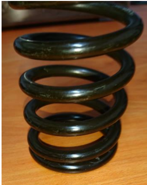
Figura 1.3: Resorte con galvanizado negro.
