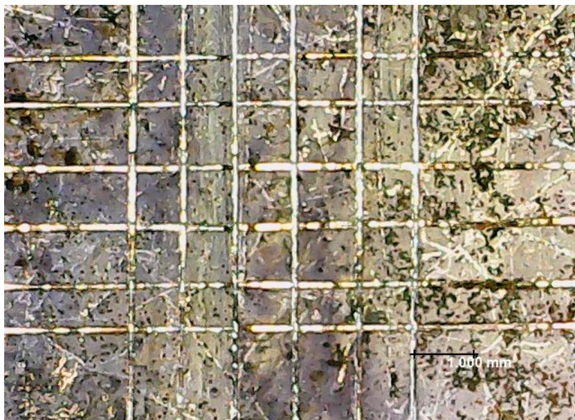
Figura 3.31: Prueba de adherencia por rayado en lámina de acero AISI-1075 cobrizado y con recubrimiento de Ag, activada con HCl-10% (experimento 2.2).
