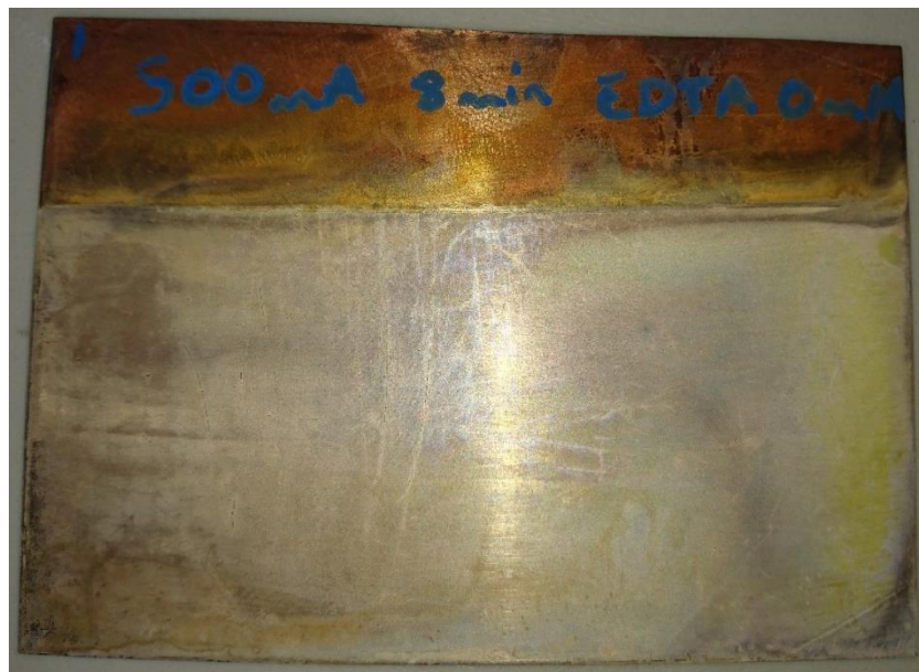
Figura 3.36: Probeta con recubrimiento de Ag sobre acero AISI-1075 cobrizado, obtenida en celda Hull sin EDTA después de 8 min a 500 mA.
