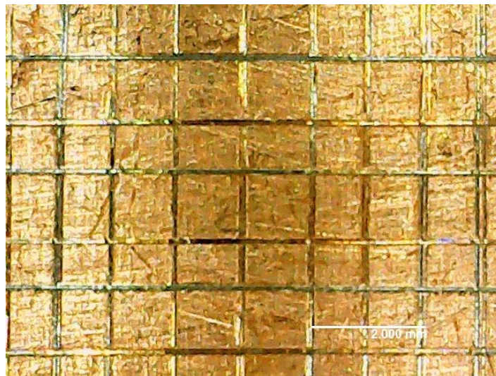
Figura 3.12: Prueba de adherencia por rayado en láminas de acero AISI-1075 recubiertas con cobre. Cuadrículas de 1 mm x 1 mm.
