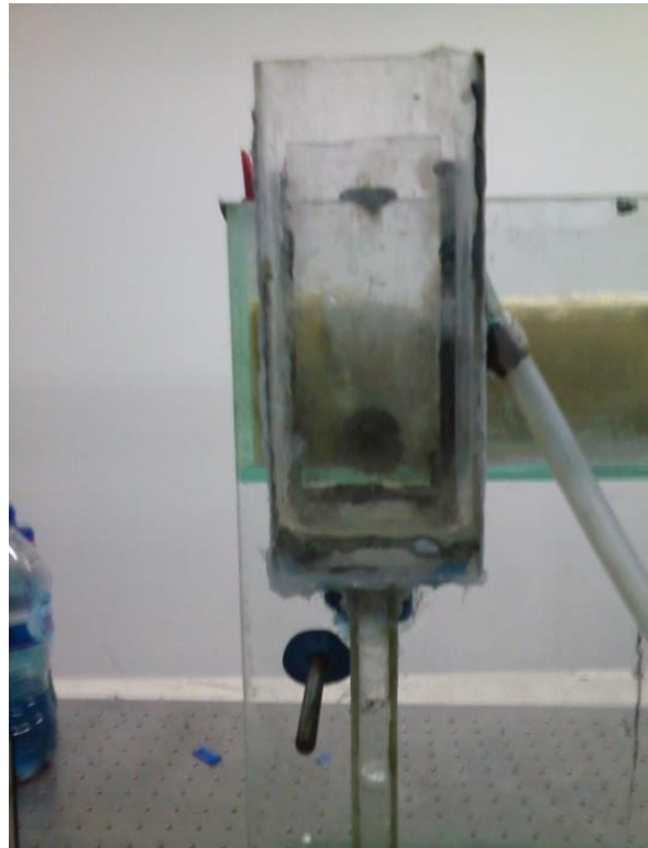
Figura II.10 Tanque superior con reducción, tubo rebosadero (a la derecha del tanque) e inicio a la zona de pruebas.
