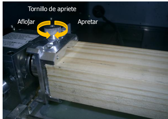
Figura 3.46. Utilizar la unidad de eje giratorio para asegurar la pieza de trabajo.
