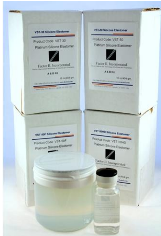
Figura 4.12. VST-50 Versital Silicone Elastomer utilizado para el modelado de la prótesis final.
