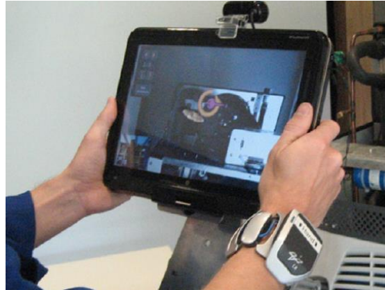
Figura 1.18. Componente móvil de realidad virtual incluyendo una pulsera háptica [83].
