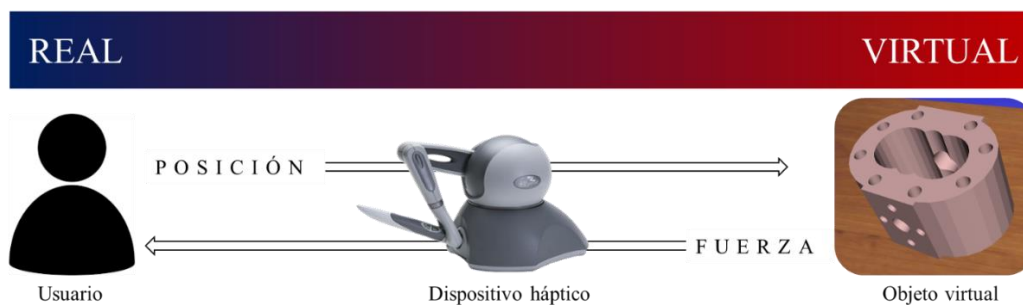
Figura 2. Principio de operación de los sistemas hápticos.
