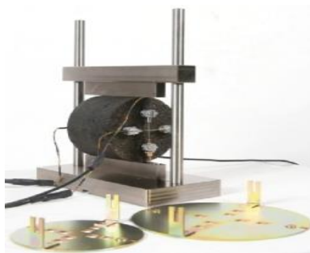
Figura 10.- Ensaye de módulo resiliente para mezclas asfálticas.
