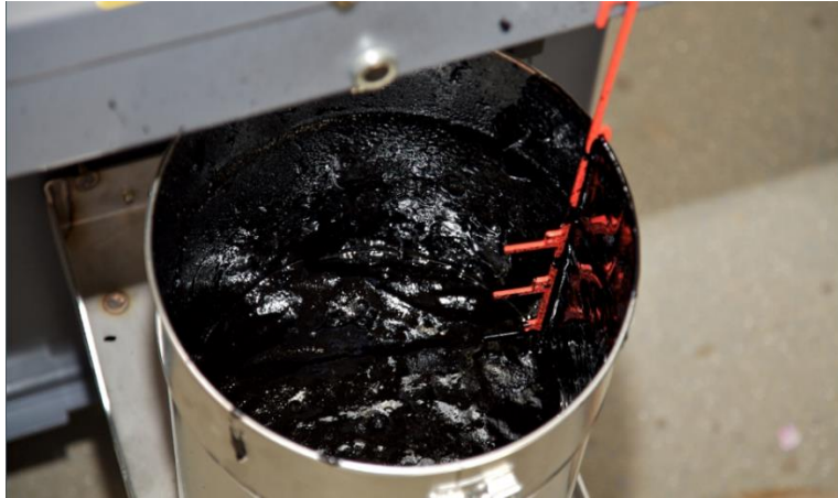
Figura 25.- Calidad de Asfalto Espumado. [26]
