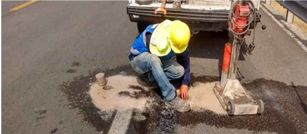
Figura 19.- Detalle de extracción de muestras con broca de 4 pulgadas sobre acotamiento km 101+000 del Libramiento de Ciudad Valles-Tamuín.
