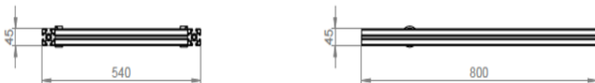
Figura 31. Soportes laterales (mm). Fuente: Elaboración Propia
