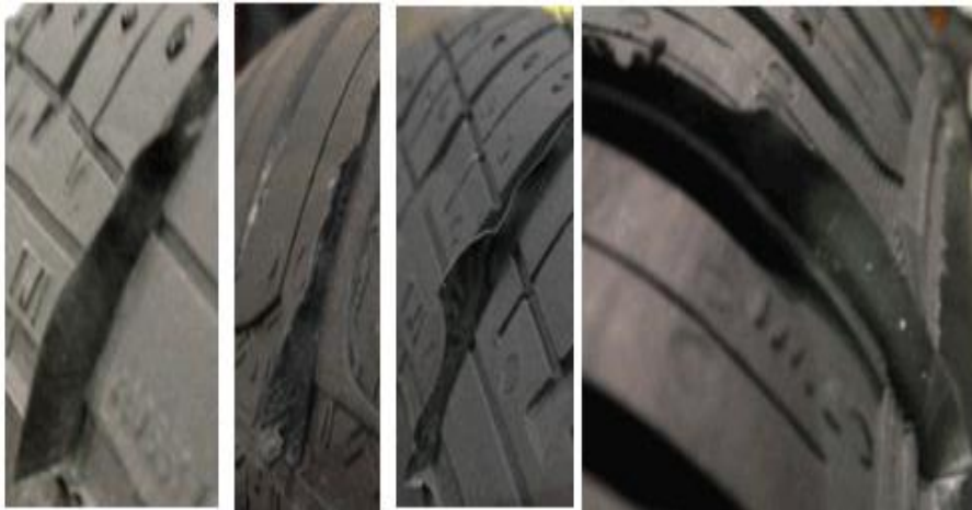
Figura 4. neumático 195/65 R15 con rebaba en ranuras. Fuente: Elaboración Propia.
