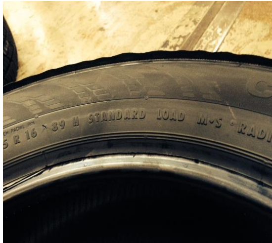
Figura 1. Ejemplo de neumático con rebaba. Fuente: Elaboración Propia.
