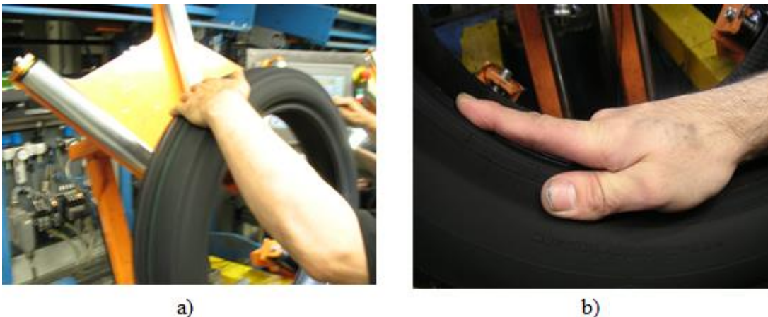
Figura 8. a) Método de inspección visual. b) Inspección manual de ceja del neumático (Fuente: Elaboración Propia)
