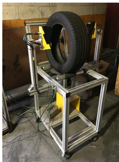
Figura 55. Prototipo Final: Sistema de detección de rebaba. Fuente: Elaboración propia.
