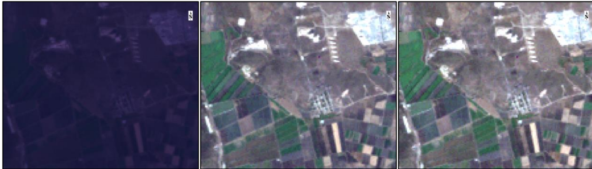
Figura 35. Imágenes multiespectrales. Sin corrección, corrección radiométrica y corrección atmosférica (de izquierda a derecha).
