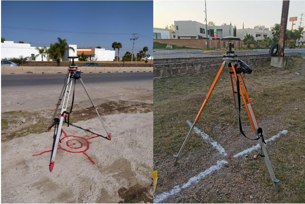
Figura 3.6.- Levantamiento estático ProMark3, puntos 13 y 14.
