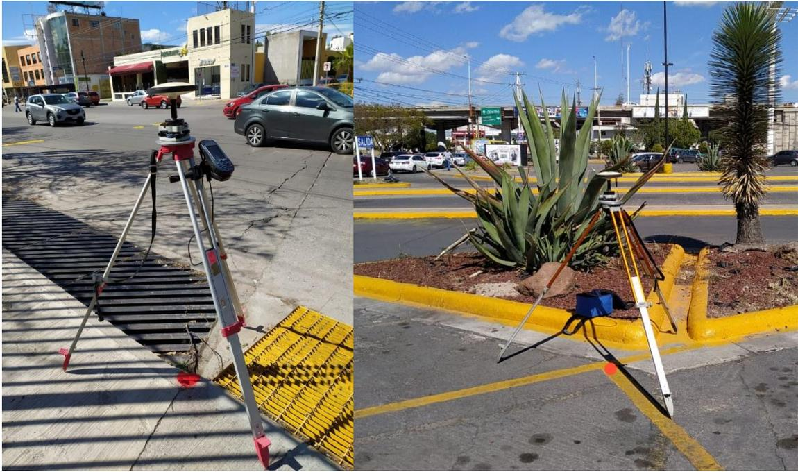
Figura 3.8.- Levantamiento estático ProMark3, puntos 18 y 19.
