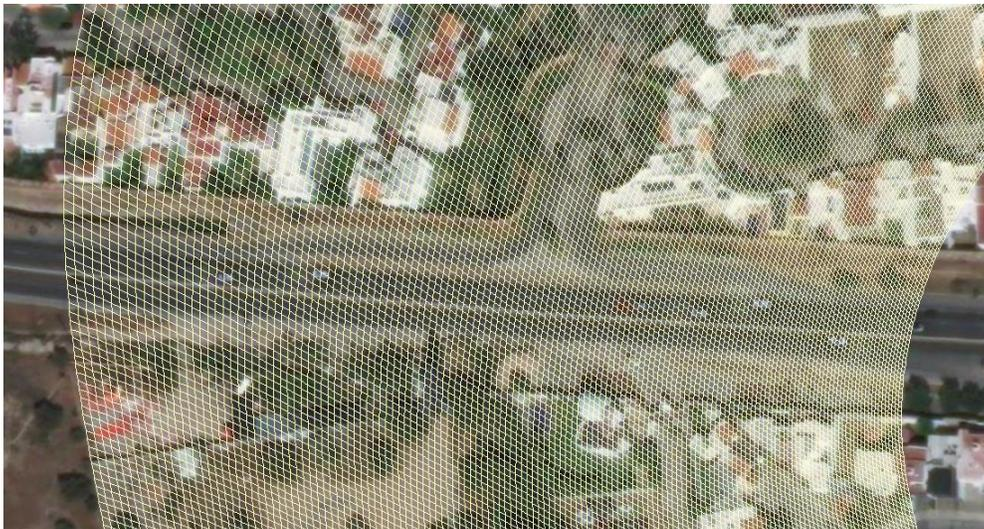
Figura 5.42.- Mallado estructurado ortogonal.
