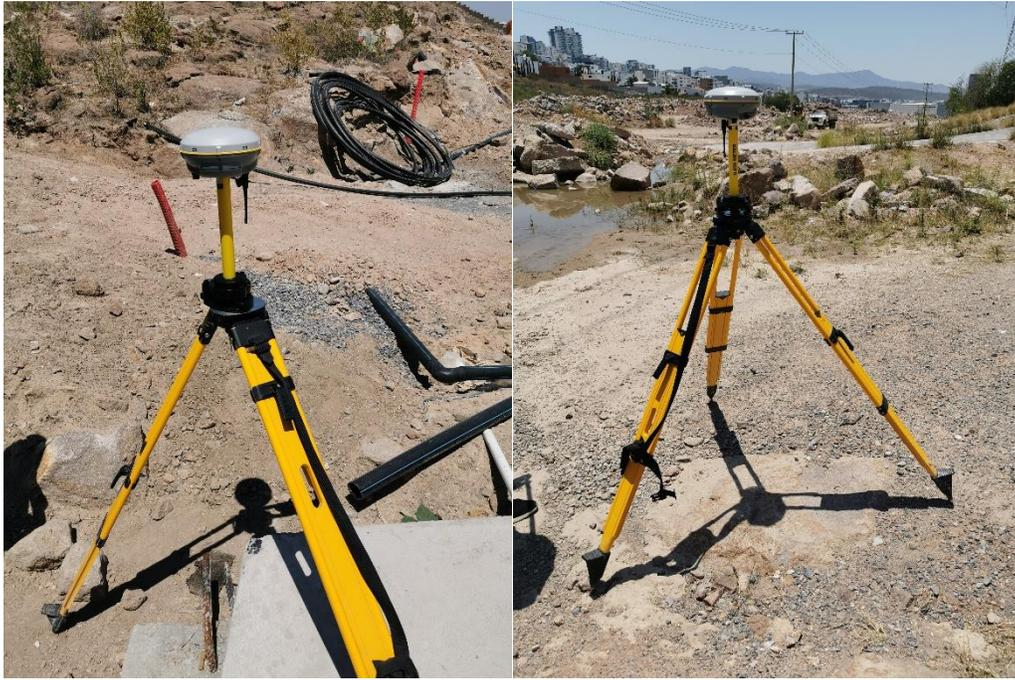
Figura 3.13.- Levantamiento estático Trimble R8s, puntos replanteados 3 y 9.
