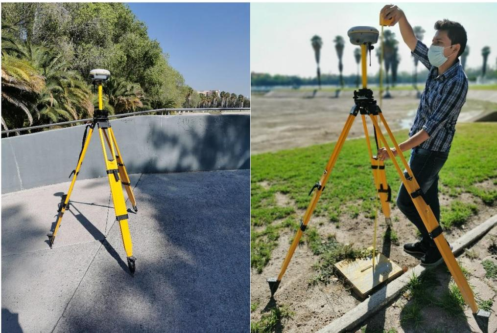
Figura 3.14.- Levantamiento estático Trimble R8s, puntos 20 y 22 replanteados.
