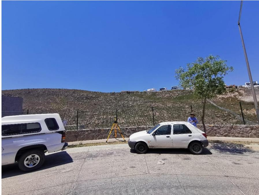
Figura 3.15.- Levantamiento estático Trimble R8s, punto 6.
