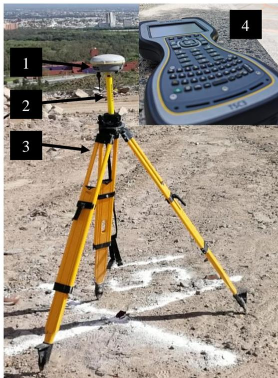
Figura 2.19.- Equipo de levantamiento TRIMBLE.
