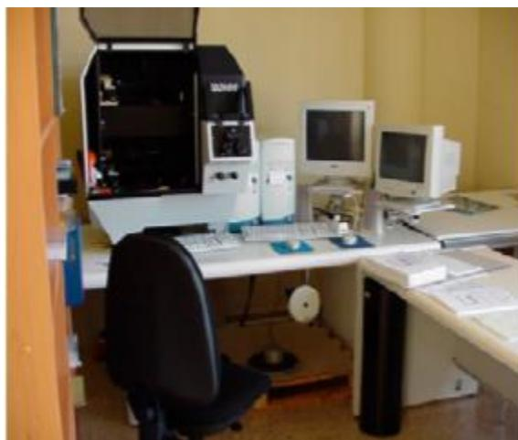
Figura 2.6.- Restituidor analógico con sistemas computacionales. (Quirós Rosado, 2014)
