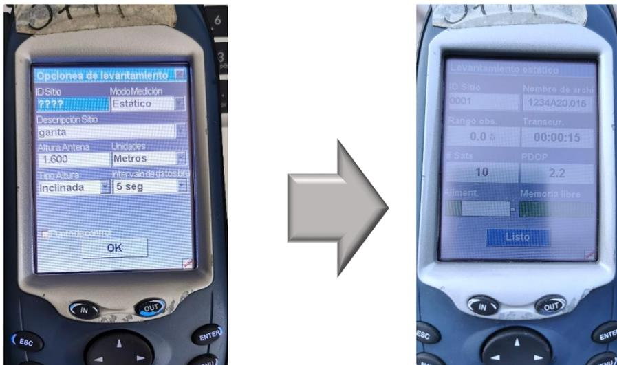
Figura 2.18.- Pantalla de unidad receptora para levantamiento estático.
