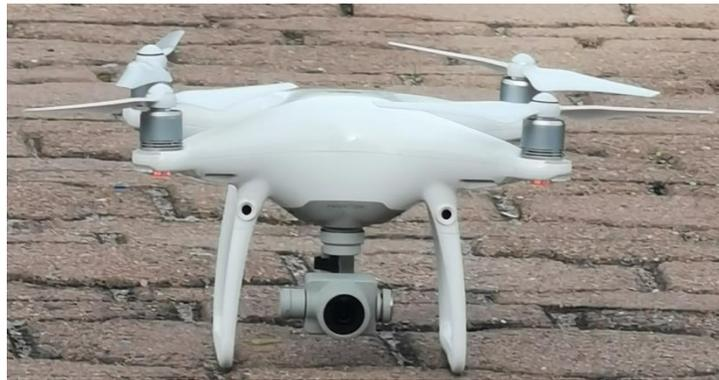
Figura 2.11.- VANT Phantom 4 pro.
