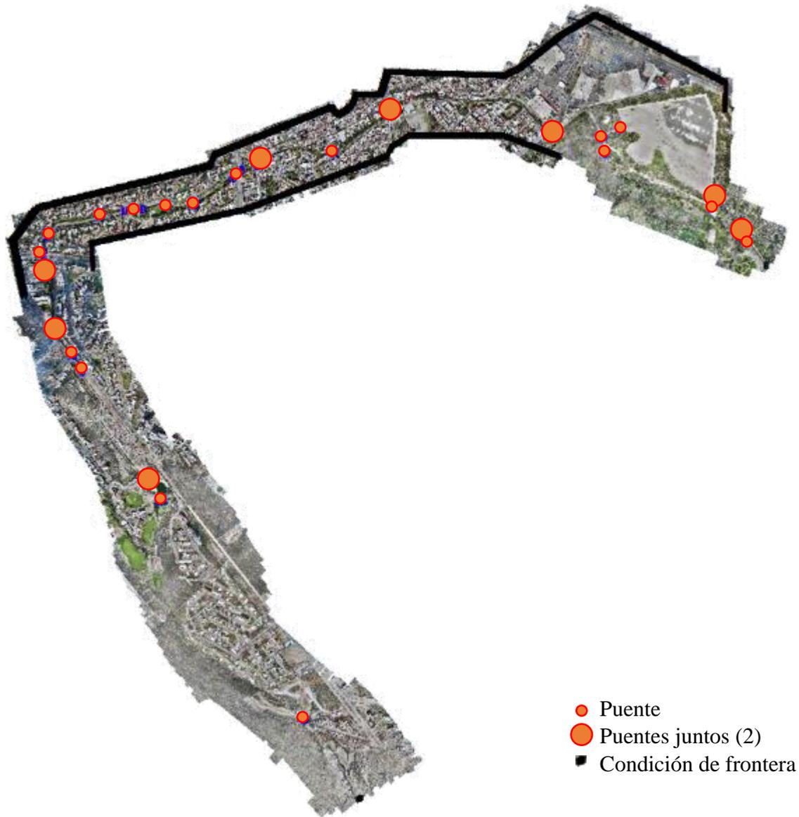
Figura 6.3.- Condiciones de frontera en el modelo.
