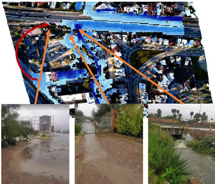
Figura 6.19.- Esgurrimiento proveniente de la Av. Sierra Vista hacia Anillo Periférico en agosto 2020, señalado en la simulación del periodo de 2 años.
