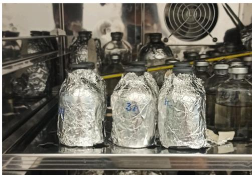
Figura 3.1 Botellas con lodo metanogénico y medio mineral en incubación
