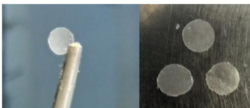
**Figura 6.2 Recorte de geomembranas de polietileno para pruebas de CMI y CMB**
