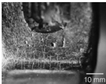
Figura 9. Agrietamiento reticular en un herramienta para forjado en caliente bajo cargas térmicas y restricción externa [34].
