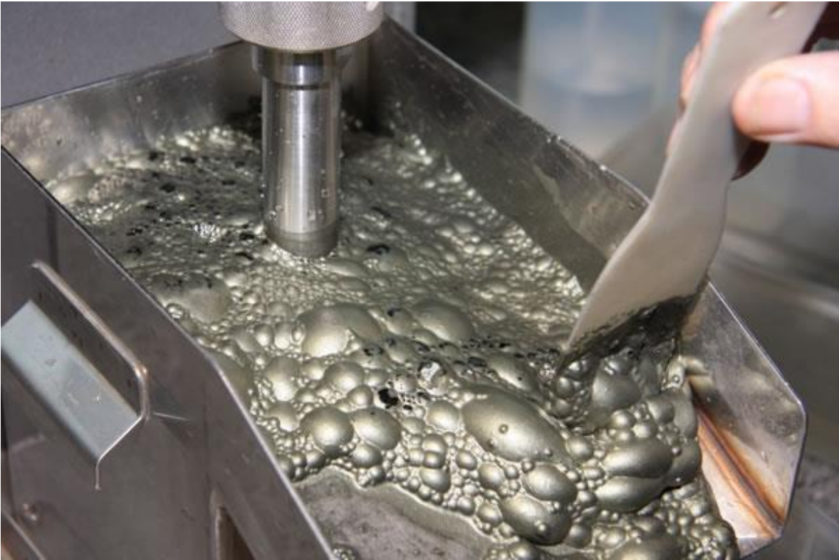
Figura 15 Prueba metalúrgica de flotación a nivel laboratorio.
