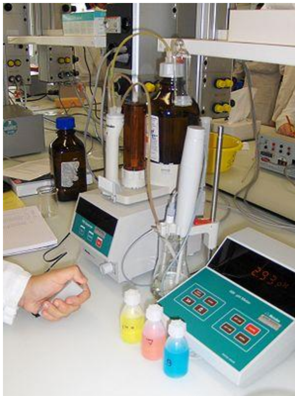
Figura 17 Determinación de plomo -cobre por método tradicional volumétrico.
