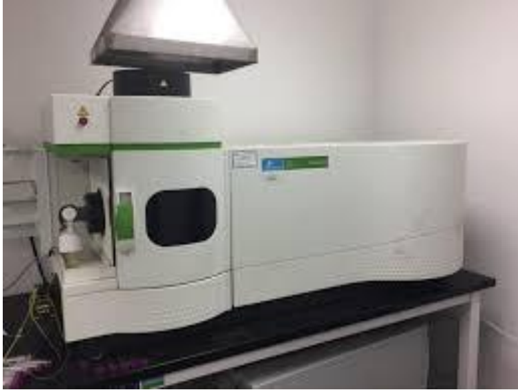
Figura 16 Espectrofotómetro Perkin – Elmer ICP-OES modelo 8300.
