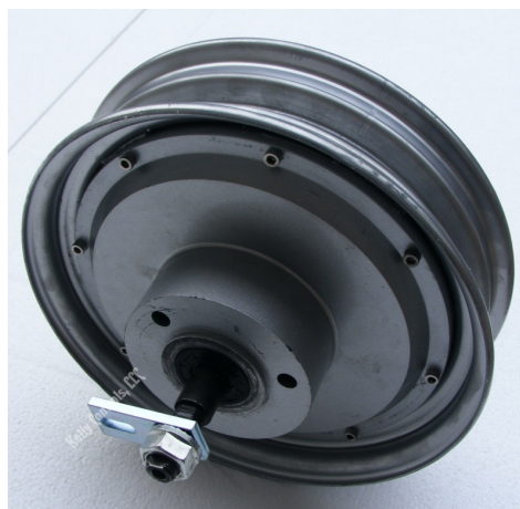
Figura 2.2: Motor en rueda disponible en el laboratorio de vehículos eléctricos.
