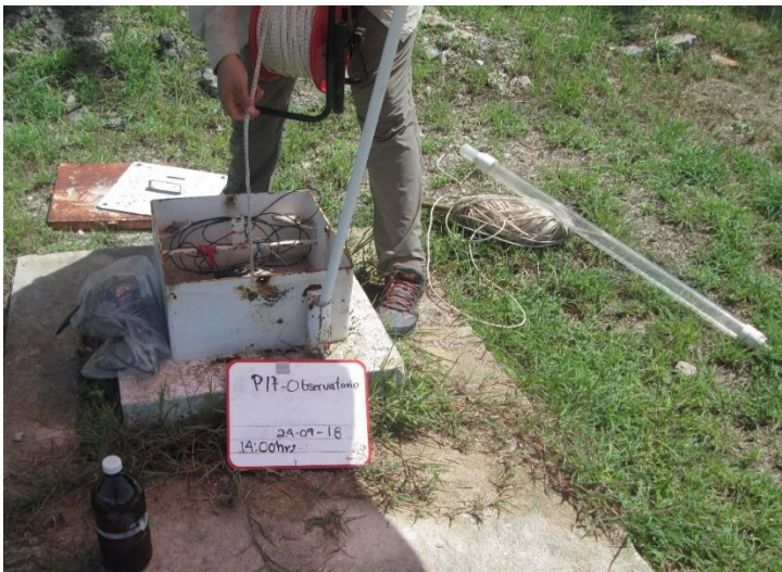
Figura 10.-Toma de la muestra y preservación de esta en botella muestreadora color ámbar.
