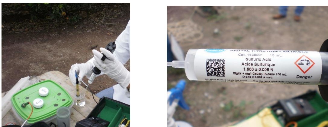
Fig. 19. Titulación potenciométrica para alcalinidad de campo, cartuchos con H 2 SO 4 .
