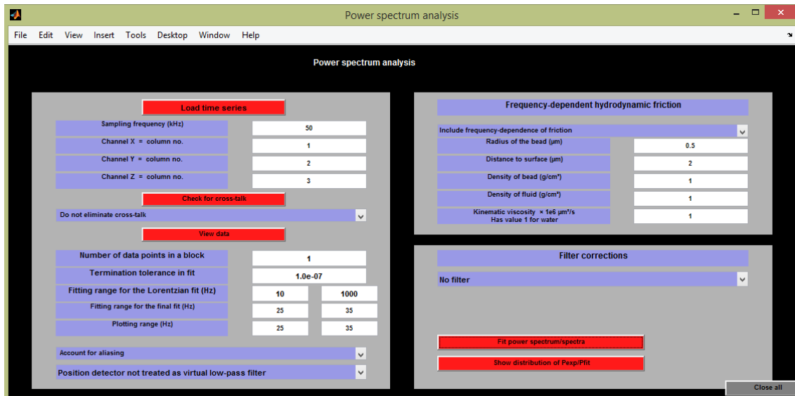
Figura 3.10 Consideraciones habilitadas y valor de los parámetros de ajuste utilizados típicamente para la obtención del factor de calibración del FDC por medio del método propuesto por Tolić-Nørrelykke et al. (2006). El único parámetro relevante fue el número de frecuencias discretas consecutivas a partir del que se realizó el blocking , éste fue de 1 con la intención de obtener el valor de la DEP justo a la frecuencia de oscilación de la muestra.
