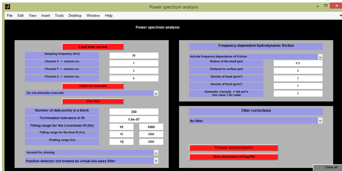
Figura 3.5 Interfaz del programa desarrollado por Tolić-Nørrelykke et al. 2004 para obtener la constante de rigidez de la PO y el factor de calibración del FDC por medio del método propuesto por Berg-Sørensen et al. (2004). a) y b) muestran las consideraciones habilitadas y el valor de los parámetros de ajuste que se utilizaron para obtener la constante de rigidez de la PO y el factor de calibración del FDC transversales y axiales, respectivamente, al atrapar partículas de 1 \mu\text{m} .
