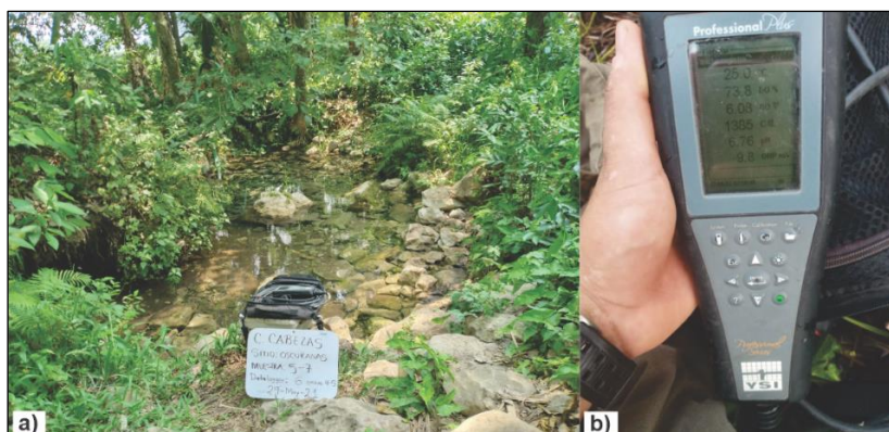
Fig. 3.2. a) Medición de parámetros fisicoquímicos en campo. b) Sonda multiparamétrica YSI profesional plus .
