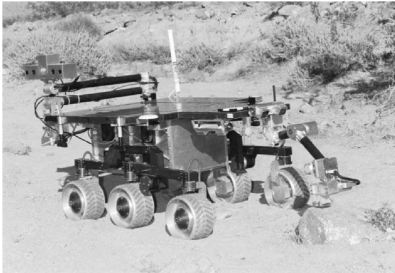
Figura 1.6: Prototipo de vehículo de exploración del planeta Marte llamado “FIDO”, controlado mediante MCSM [5].
