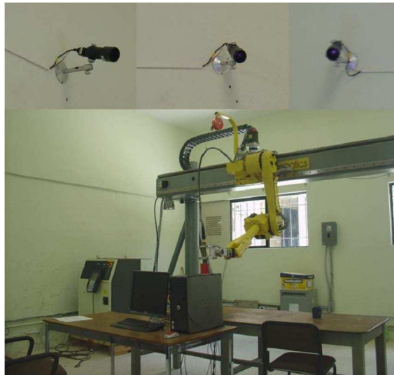
Figura 1.7: Robot Fanuc M16ib/20T; robot de amplio espacio de trabajo, controlado con CSM mediante múltiples cámaras [6].
