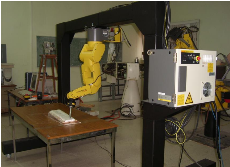
Figura 3.1. Sistema robótico Fanuc: robot LR-Mate 200iC, controlador R30iA Mate y sensor de fuerza/torque FS-10iA.
