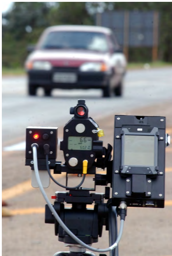
Figura 1.8. Radar de control de velocidad operado bajo el principio del efecto Doppler.
