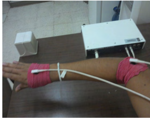
Figura 4.2. Sensores de posición colocados en la palma de la mano y en el codo para la determinación del valor de la longitud del antebrazo.
