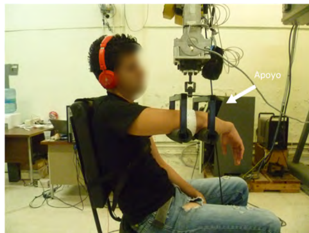
Figura 4.10. Sujeción de paciente para la evaluación de la rigidez en el hombro.
