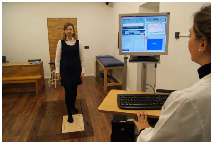
Figura 1.10. Plataforma dinamométrica, análisis de las fuerzas resultantes durante la marcha.
