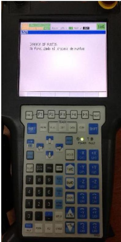
Figura 3.13. Teach pendant indicando finalización del grabado de la trayectoria.
