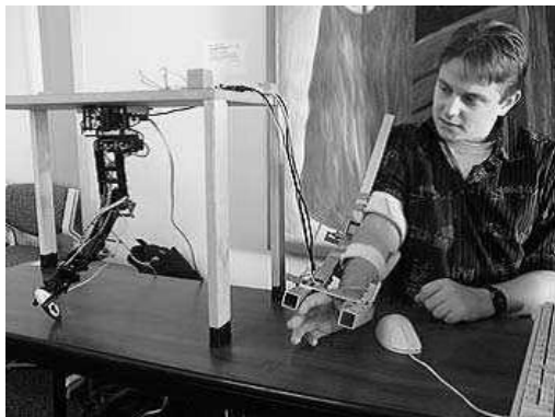
Figura 2.4: Enlace maestro rígido
