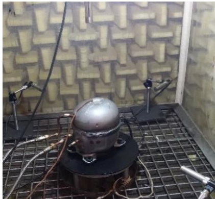
Figura 3.10. Montaje de compresor dentro de la cámara anecoica.
