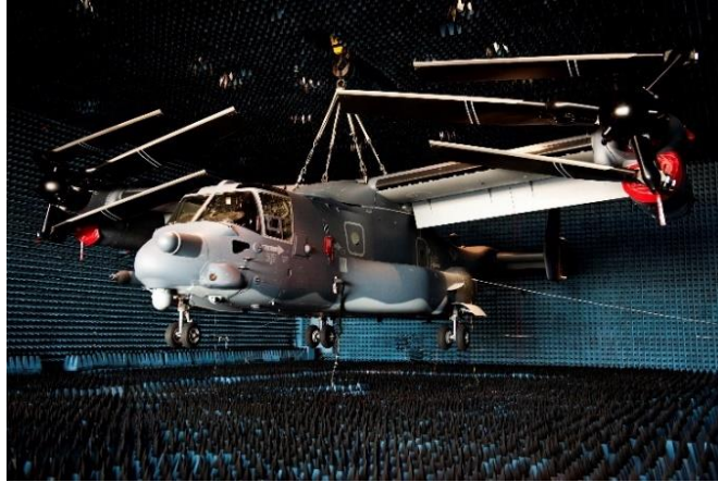
Figura 1.13. Cámara anecoica J-PRIMES.
