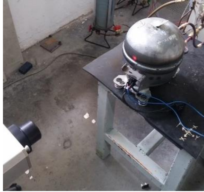
Figura 3.11. Montaje de compresor en el banco de pruebas para medición con el vibrómetro láser.
