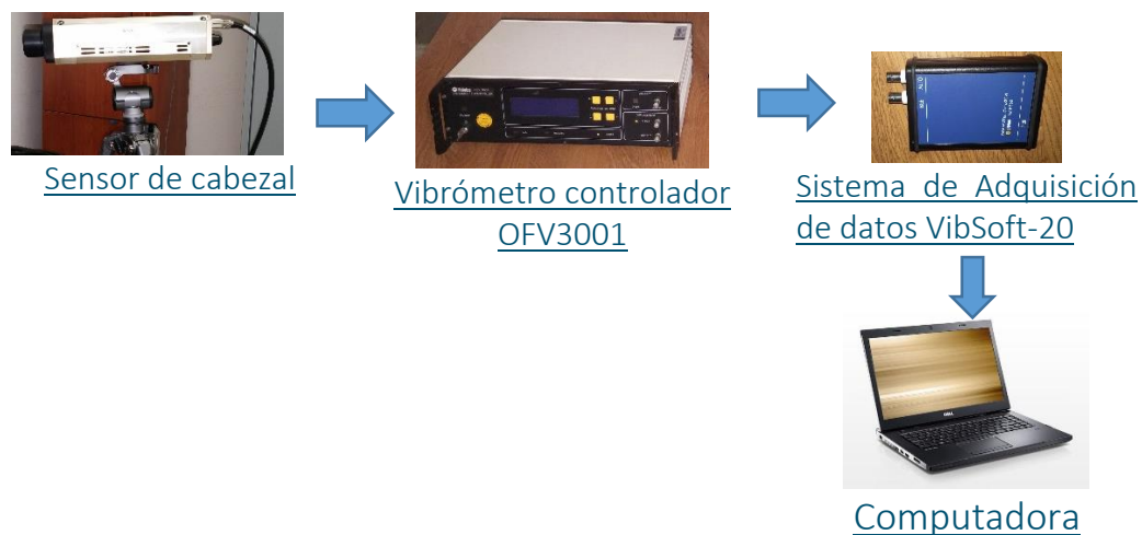
Figura 3.6. Cadena de medición con el sistema de vibrómetro láser
