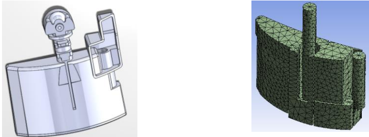
Figura 4.12. (a) Modelo CAD del ensamble de la mufla competencia, (b) modelo del volumen de fluido a analizar
