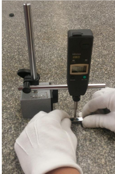
Figura 4.14 Comparación contra bloque patrón de un indicador digital.
