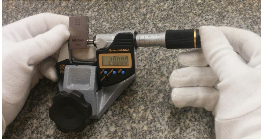
Figura 4.13 Comparación contra bloque patrón del micrómetro.
