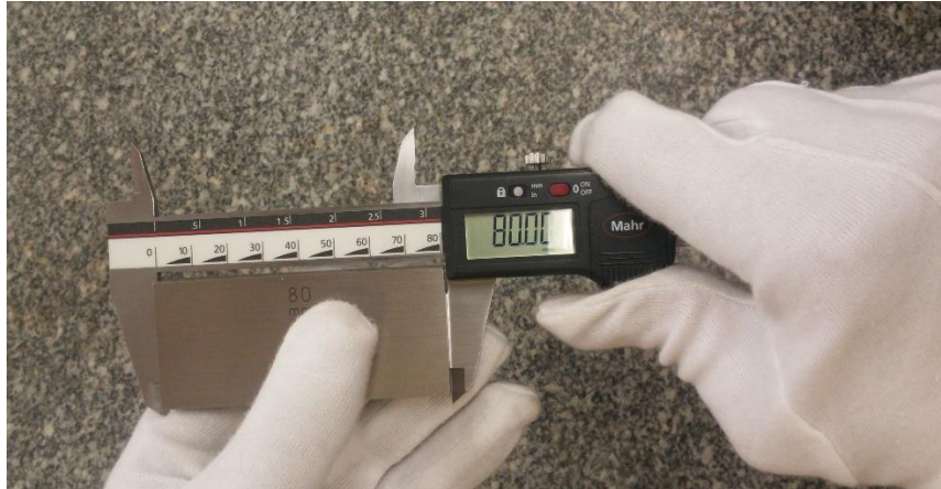
Figura 4.12 Comparación contra bloque patrón del calibrador.
