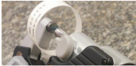
Figura 2.7 Contacto de las caras con plano óptico.
