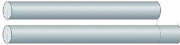
Figura 1.17. Pieza de medición dilatada.
