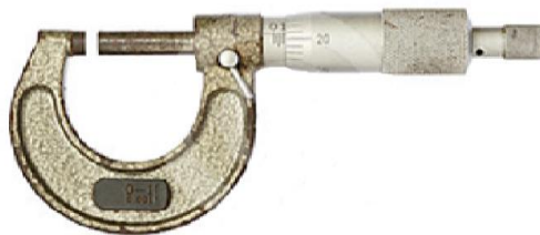
Figura 1.18 Equipo de medición oxidado.
