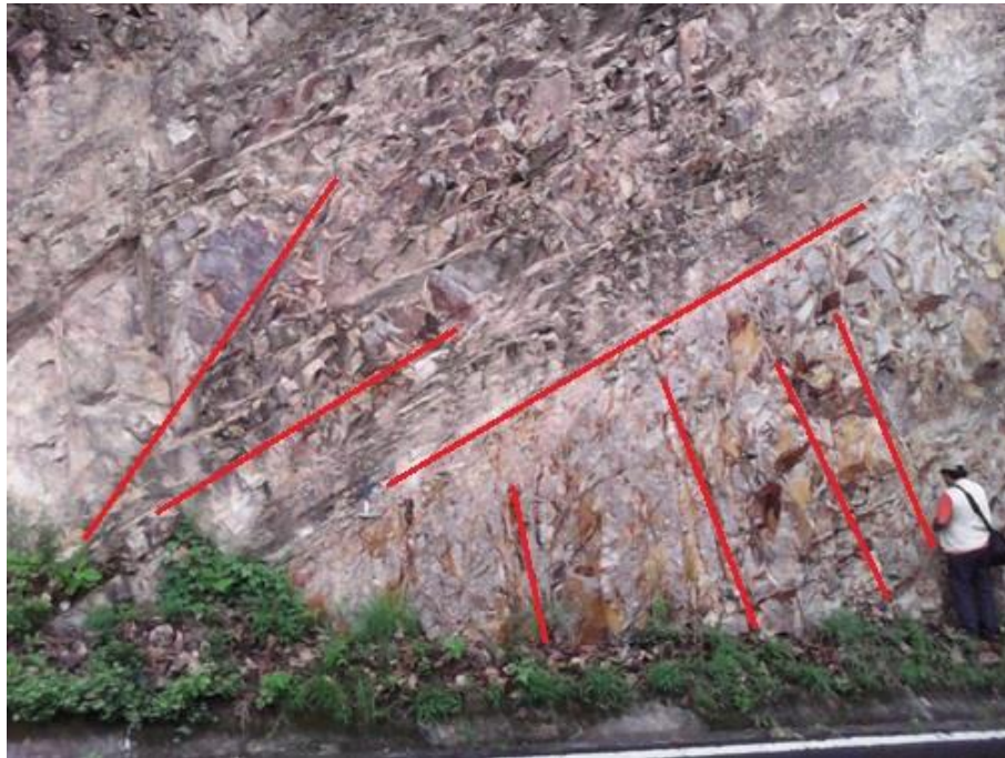
Figura 21: Se observa un afloramiento de riolita, en la cual se pueden observar diferentes fracturas.
