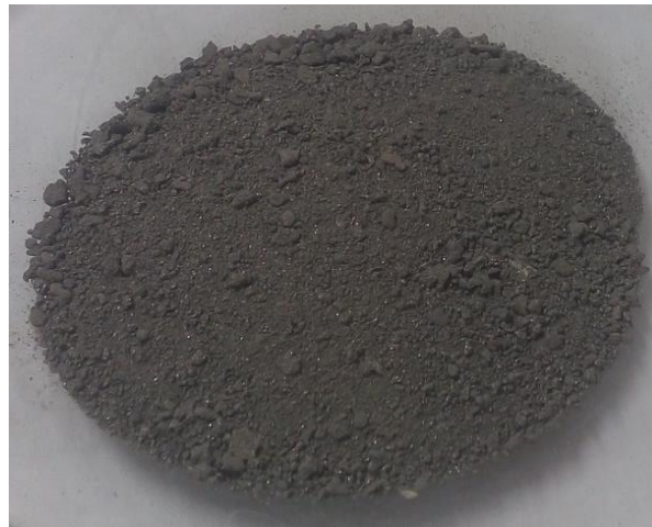
Figura 14. Compósito RL1 de residuos obtenidos en pruebas de lixiviación de concentrados de cobre
