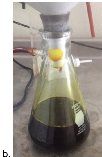
Figura 30. Residuo sólido (a) y licor de lixiviación (b) generados en el proceso de remoción de azufre del RL1 mediante lixiviación con \text{Na}_2\text{S} y \text{NaOH} .
