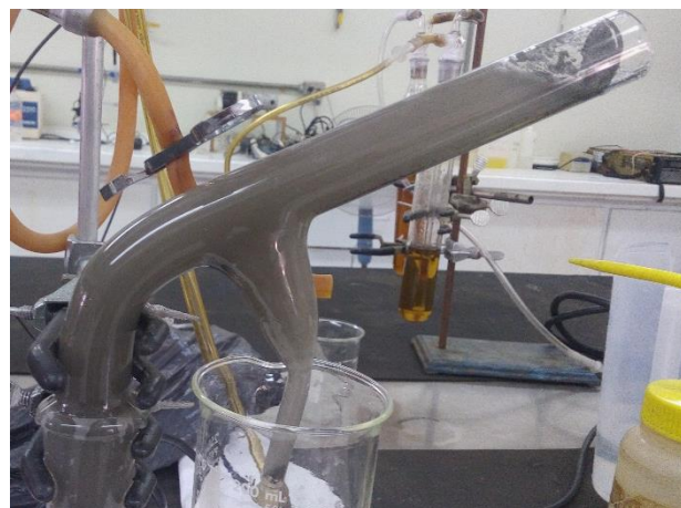
Figura 26(a). Pulpa mineral en vaso de precipitados después del acondicionamiento sin modificar el pH. (b) Pruebas de microflotación sin modificar el pH.
