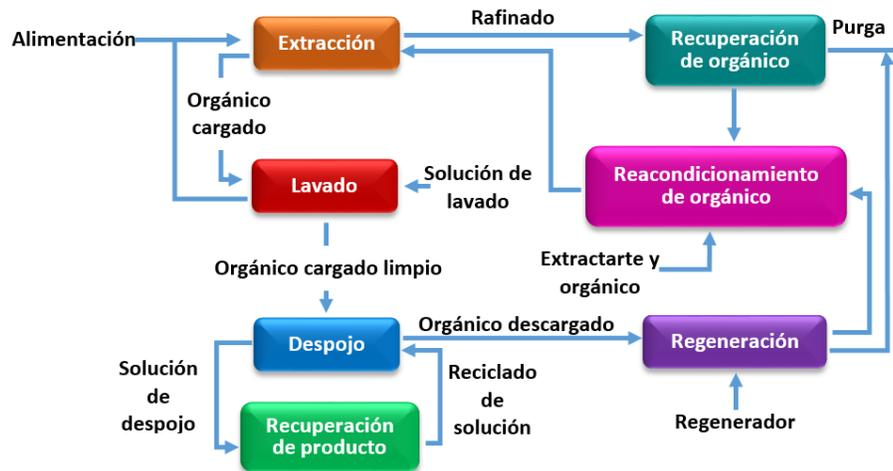
Figura 2.6: Procesos de extracción líquido-líquido para conseguir productos de alta pureza [11].
