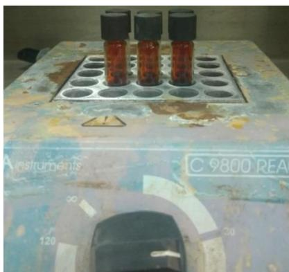
Figura 3.1: Reactor C 9800 de maraca HANNA INSTRUMENTS con tubos en reacción
