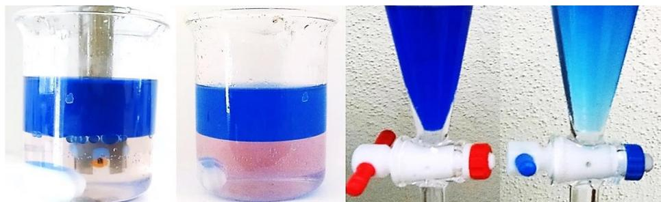
Figura 5.10: Apariencia de fases antes y después de despojo ácido de Cyanex 272.
