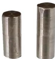
Figura 4.1: Barras de níquel usados como electrodos.
