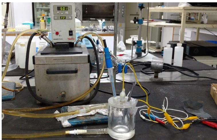
Figura 5.47: Sistema utilizado para realizar pruebas electroquímicas.
