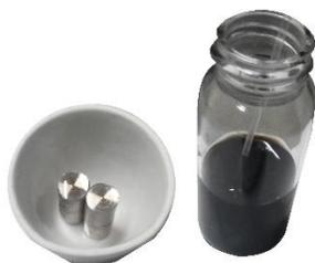
Figura 4.2: Barras de níquel para colocarles nanopartículas en la superficie plana antes de entrar a la mufla.
