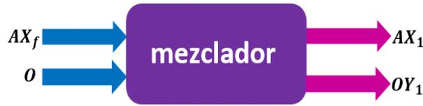
Figura 2.2: Extracción líquido-líquido de contacto simple.
