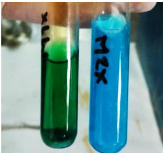
Figura 5.2: Lixiviación total de residuo de cobre. Derecha:  $H_3NO_4$ . Izquierda:  $H_3NO_4/H_2O_2$ .
