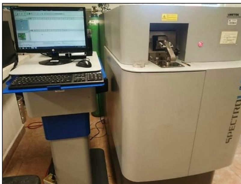
Figura 19. Espectrofotómetro de emisión óptica por chispa marca Spectro modelo LabS.
