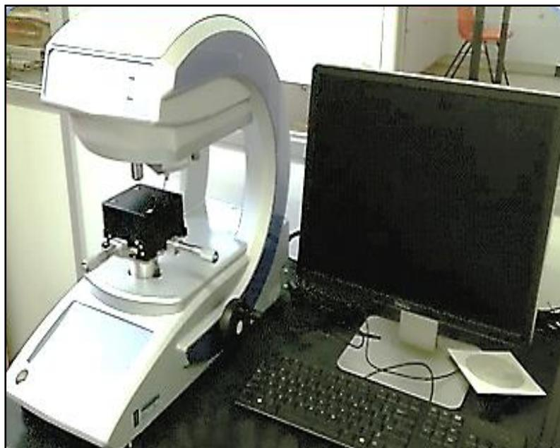
*Figura 22. Microdurómetro semiautomático Shimadzu HMV-G.*
