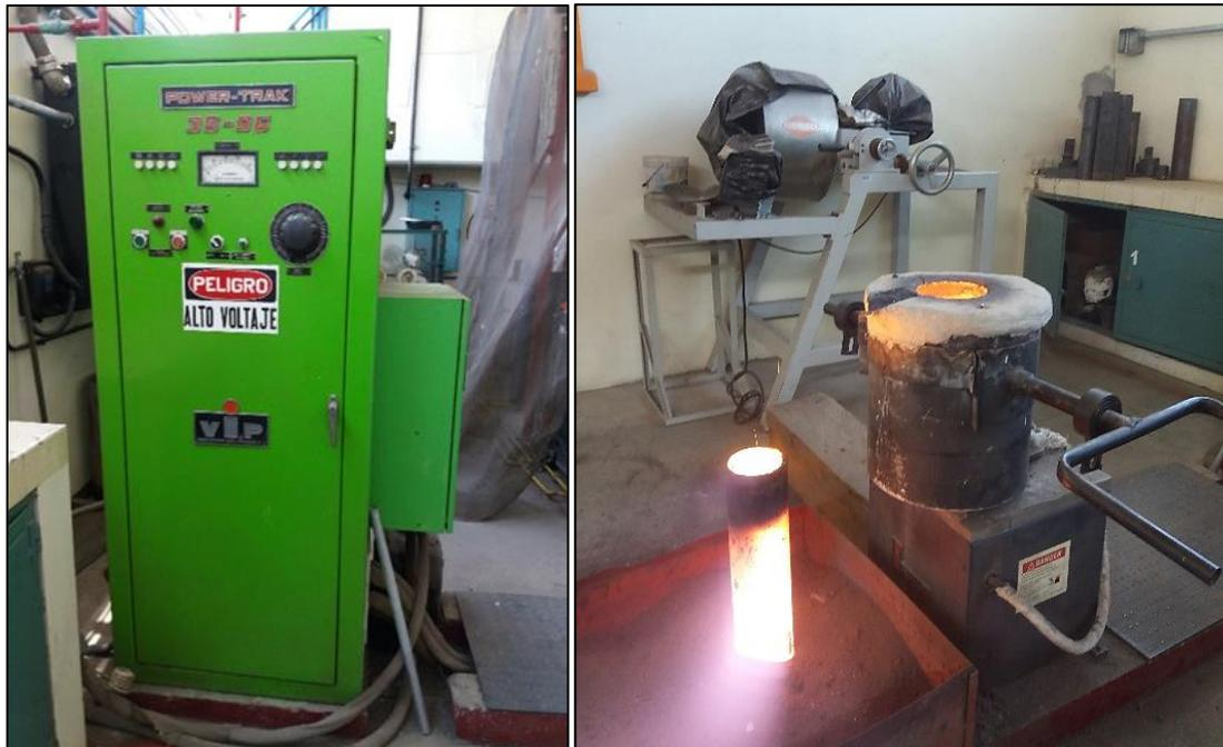
Figura 11. Horno de inducción Power-Trak 35-96.
