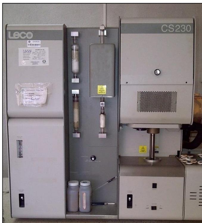
Figura 18. Determinador simultáneo de C y S marca Leco modelo CS 230.
