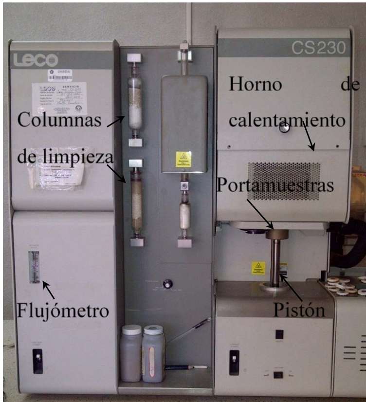
Figura 19. Determinador simultáneo de C y S marca Leco modelo CS 230.
