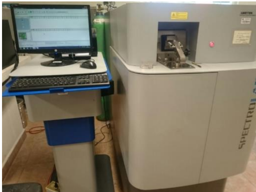
Figura 20. Espectrofotómetro de emisión óptica por chispa marca Spectro modelo LabS.
