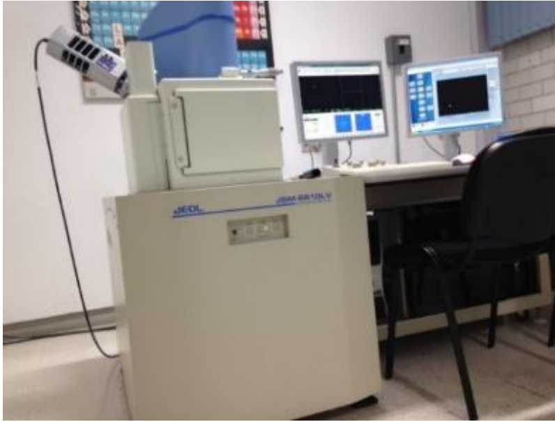
Figura 24. Microscopio electrónico de barrido marca JEOL modelo JSM-6610LV.
