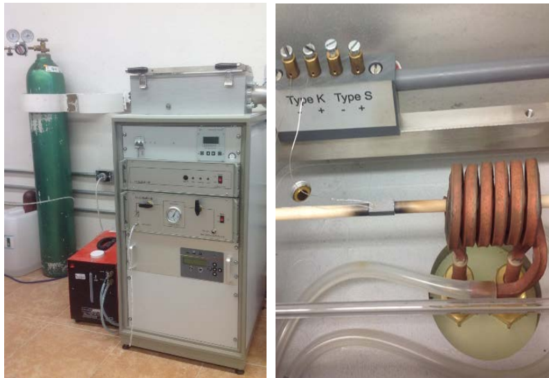
Figura 25. Dilatómetro marca LINSEIS modelo L78.
