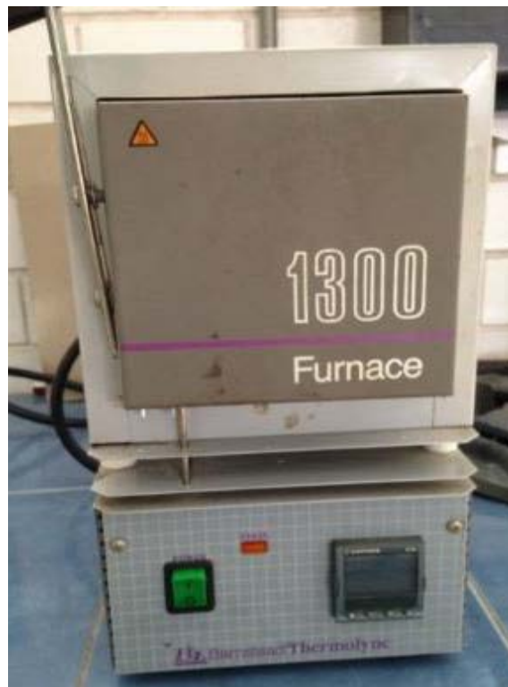
Figura 18. Horno-mufla Thermolyne modelo 1300.
