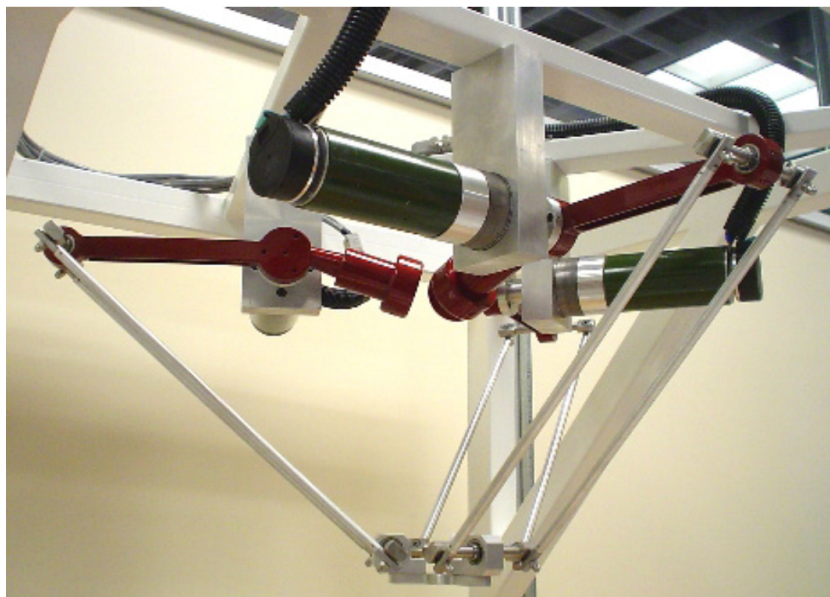
Figura 1.11. Robot paralelo tipo Delta modelo educativo LKF-2040 (tomado de [18]).
