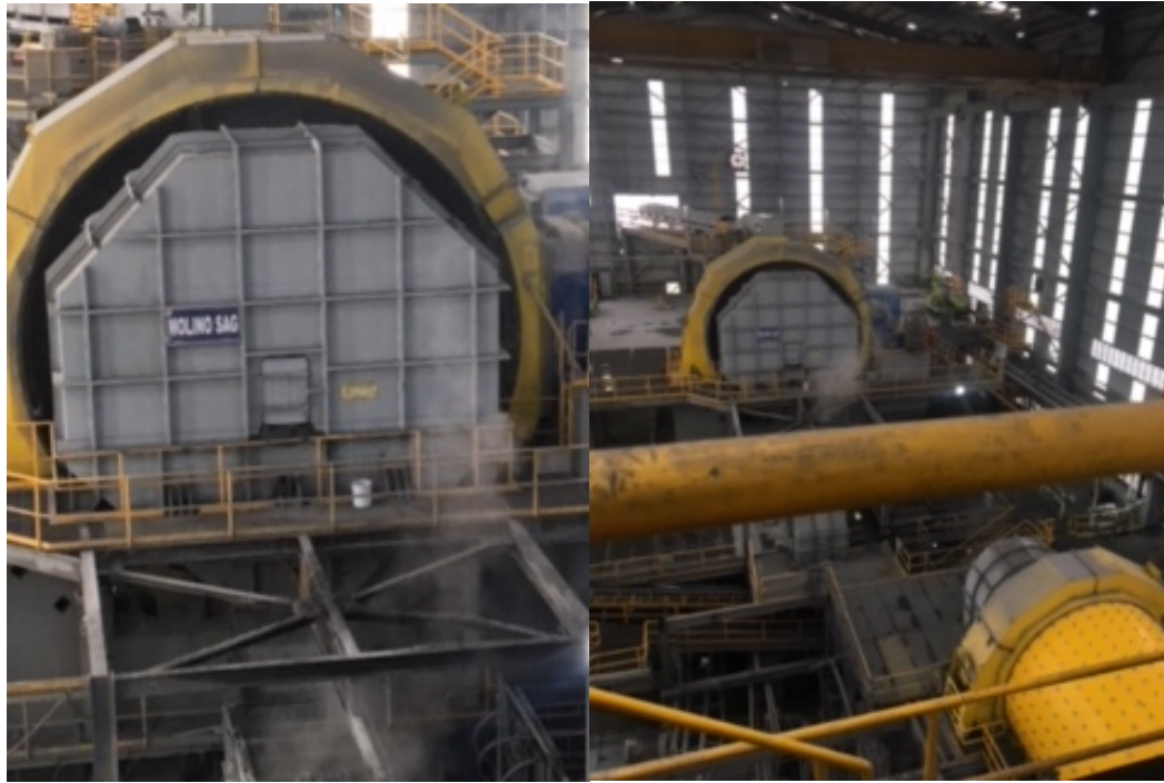
Figura 19.- Vistas de molino SAG y molino de bolas Unidad Velardeña, Dgo.
