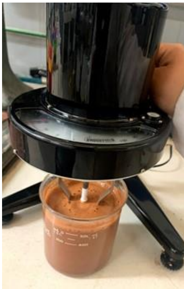
Figura 20. Viscosímetro de lectura de dial de Brookfield® utilizado para la medición de viscosidad de las pulpas de flotación.
