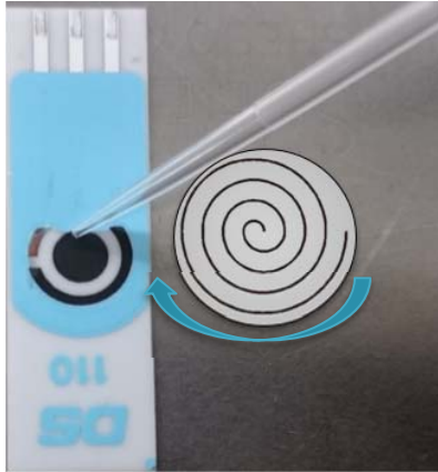
Figura 11 Modificación del electrodo de trabajo Dropsens, donde la alícuota debe colocarse en forma de espiral para que cubra toda la superficie.
