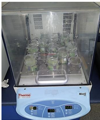
Figura 15. Sistemas en batch para las pruebas de equilibrio y cinéticas
