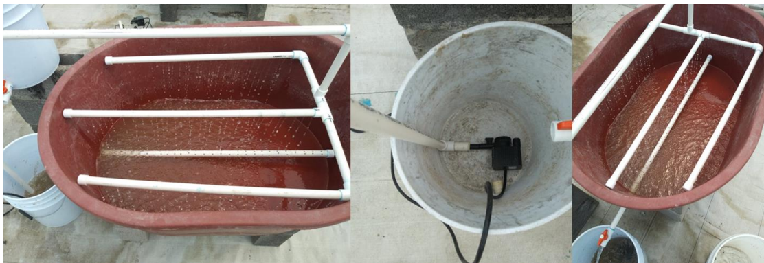
Figura 12. Construcción de los prototipos de humedales de FVSS
