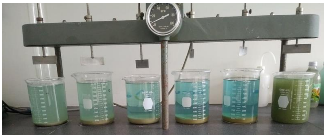
Figura 11. Sistema para las pruebas de jarras de los diferentes reactivos precipitantes
