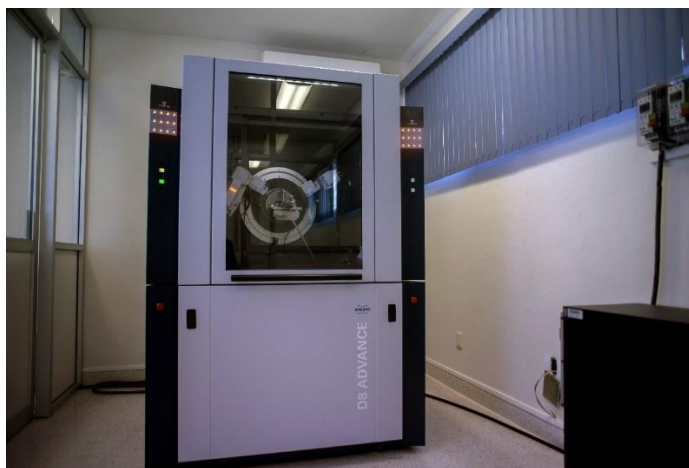
Figura 26. Difractómetro del laboratorio de DRX Bruker modelo D8-Advance Davinci.
