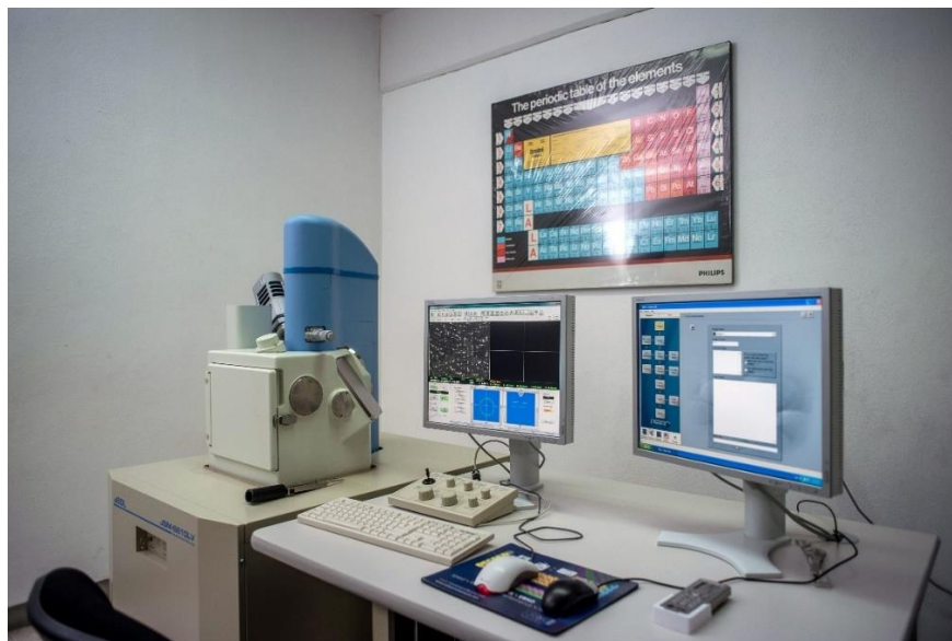
Figura 27. Microscopio electrónico de barrido Jeol modelo JSM-6610LV.
