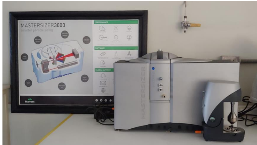
Figura 28. Analizador de tamaños de partículas Malvern Mastersizer3000.
