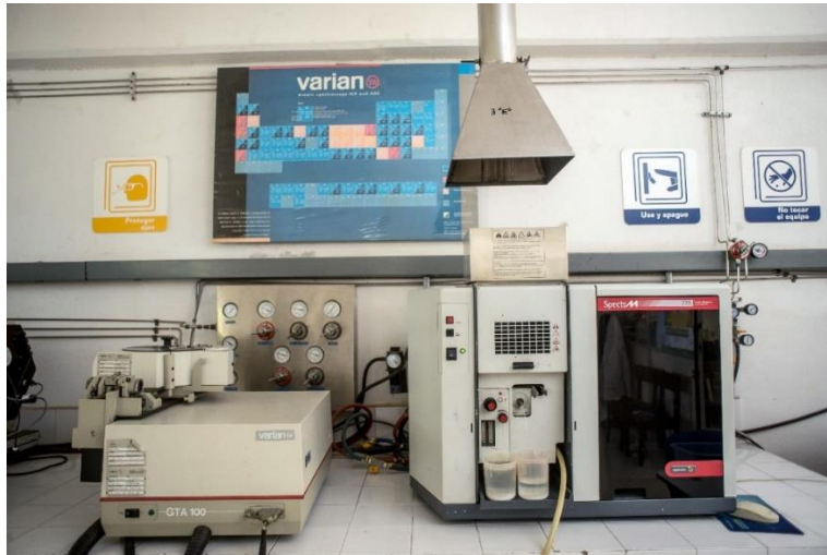
Figura 25. Equipo de absorción atómica Varian modelo 220.
