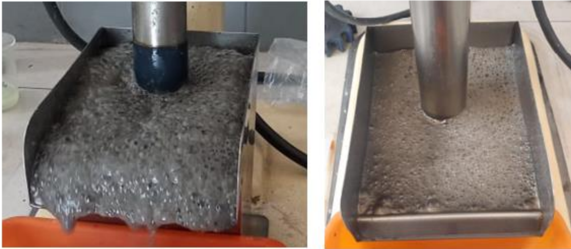
Figura 66. Flotación con efecto de arrastre mecánico: del primario (izquierda) y agotativo (derecha).
