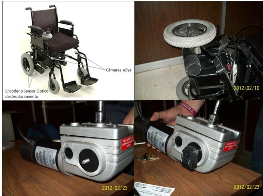
**Figura 3.7.** Modificación de caja de transmisión para montaje de encoders.
