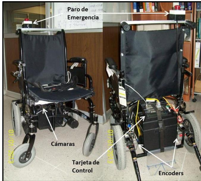
**Figura 3.8.** Elementos utilizados para la realización de las técnicas de control y navegación.
