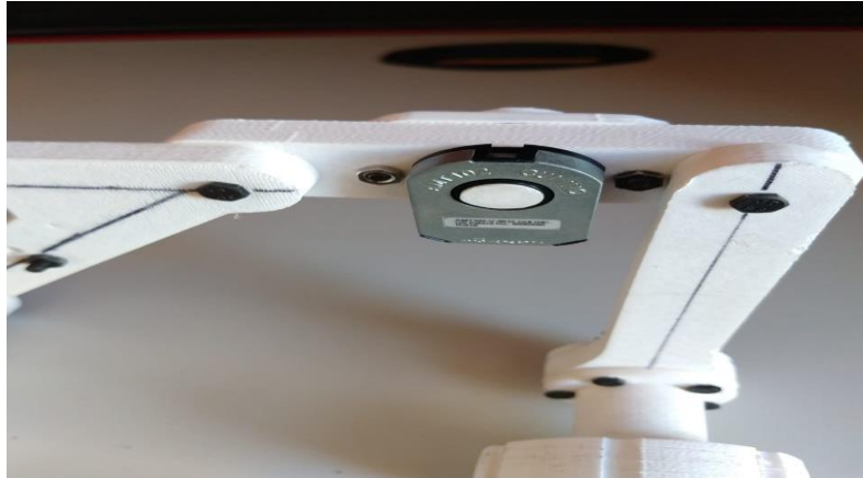
Figura 5.3. Encoder AMT102-V montado en junta rotativa de plataforma de carga
