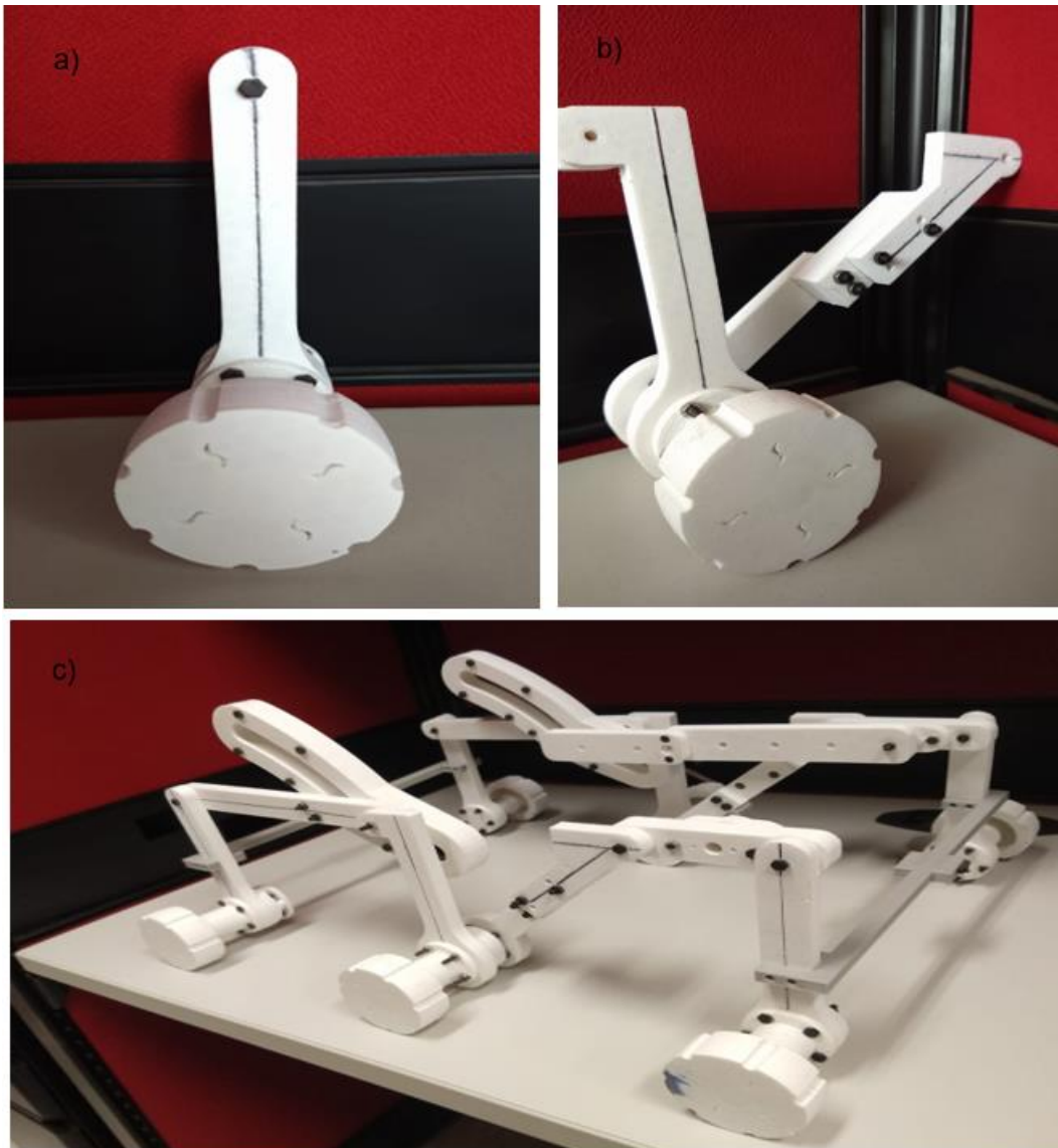
Figura 4.24. Ensamblajes a) Llanta frontal. b) Llanta central. c) Suspensión completa.
