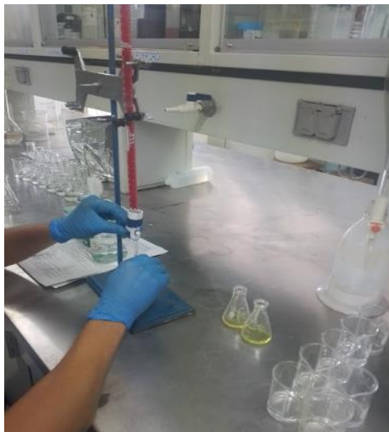
Figura 1.9. Determinación de cloruros: muestras a las que se agregó cromato de potasio.
