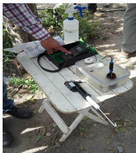
Figura 1.6. Bureta digital utilizada para la titulación.
