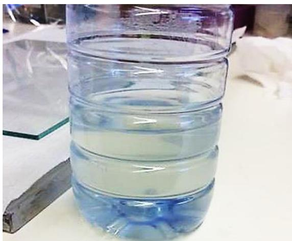
Figura 10. *Casting solution* CA400-30 con 0.1% de fluoruro de calcio.
