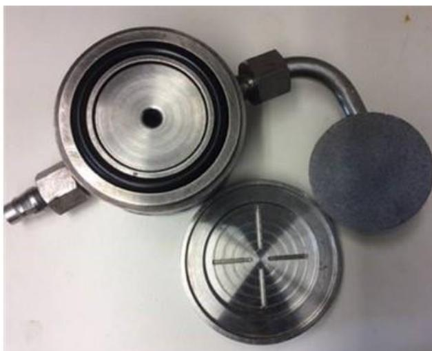
Figura 14. Celda de permeación usada en la instalación de ultrafiltración.
