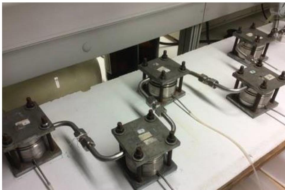
Figura 13. Instalación de celdas de ultrafiltración.
