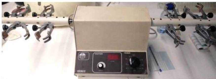
Figura 9. Agitador mecánico P Selecta Vibromatic.
