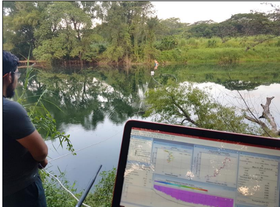
Figura 3.39. Uso del software WinRiver II para determinar caudales.
