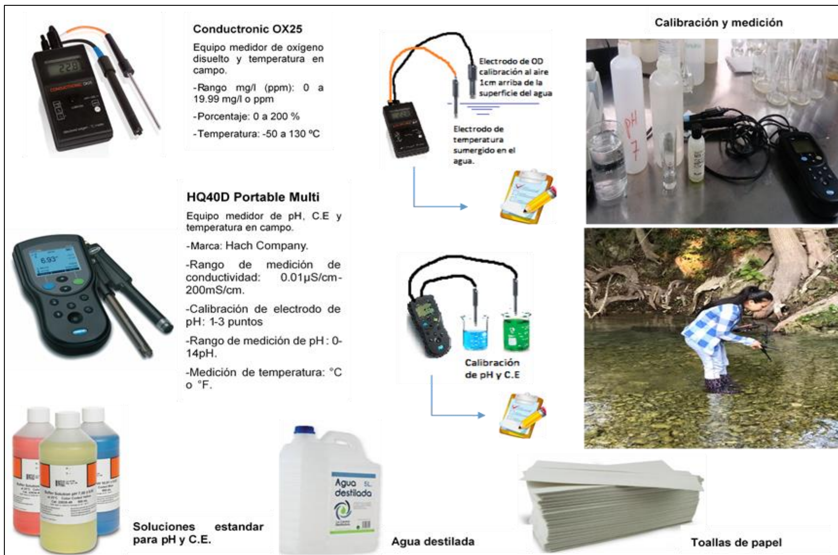
Figura 3.41. Esquema de integración de equipos para medición de parámetros de calidad del agua in situ .
