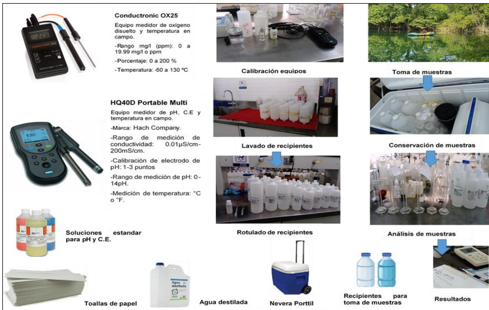
Figura 3.44. Esquema de integración de equipos para toma de muestras para el análisis de calidad del agua.
