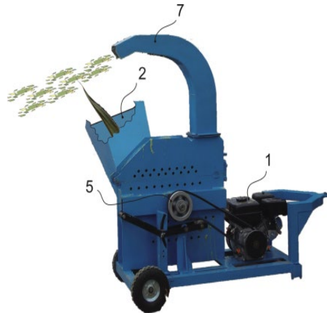
Figura 3. Máquina para picar maguey y nopal. Fuente: Elaboración propia.
