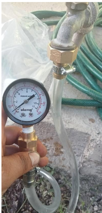
Figura 34. Manómetro empleado para toma de presiones.
