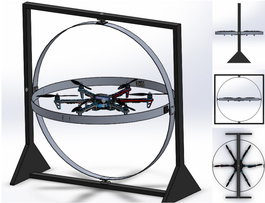
Figura 5.15: Banco de pruebas de orientación basado en el soporte de cardán. El mecanismo dota al multirroto de tres grados de libertad de orientación ( \phi, \theta, \psi ) mientras anula la dinámica de traslación, garantizando un entorno seguro para la validación de las leyes de control de orientación.
